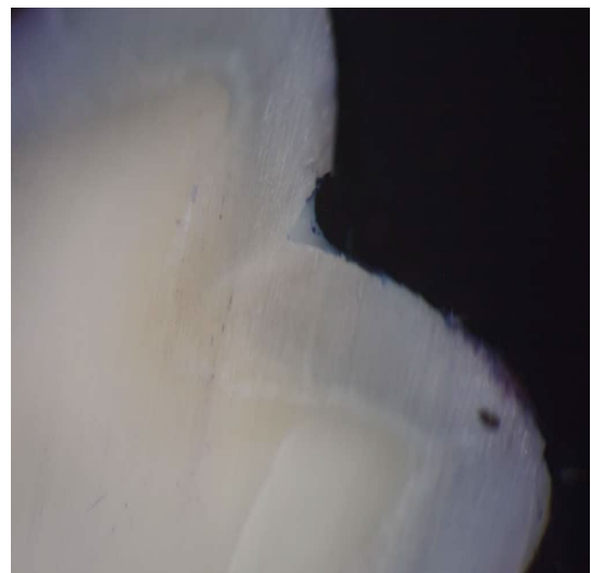
تصویر ۲. تصویر استریومیکروسکوپ با بزرگنمایی ۴۰ برابر از ریزنشت درجه‌ی ۱
