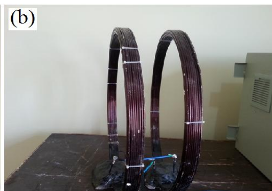
شکل ۱. مدار اصلی (الف) و سیم‌پیچ هلمولتس (ب) که برای تولید میدان‌های مغناطیسی متناوب در این مطالعه استفاده شدند.
