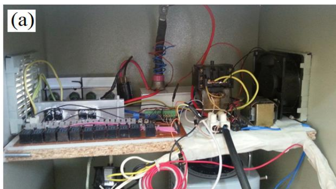
شکل ۱. مدار اصلی (الف) و سیم‌پیچ هلمولتس (ب) که برای تولید میدان‌های مغناطیسی متناوب در این مطالعه استفاده شدند.
