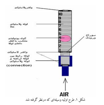
فرمول کلی برای حرکت گوی به قرار زیر است(۵): P: فشار داخل کل سیستم(از لوله تا ریهها. سیستم بسته فرض شد پس فشار در لوله وریه برابر است) F1: نیروی وارده بر گوی یونولیتی F2: نیروی وارده بر ریه ها A1: سطح گوی M2: سطح داخلی ریه m3: شتاب گرانش زمین h : ارتفاعی که گوی بالا میرود FX: نیروی لازم برای حرکت گوی R3: مقاومتهای موجود در کل سیستم
